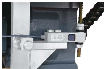
Die Erfassung der zu ermittelnden Prüfwerte erfolgt über das bewährte DMS-Messprinzip. Diese verschleissfreie Messsensorik ermittelt zuverlässig und fehlerfrei die entstehenden Kräfte.
