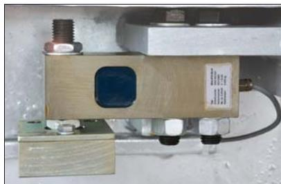
Mit der Achs- oder Radlastwaage werden die Gewichte automatisch erfasst, berechnet und gespeichert. Die Werte werden auf der integrierten LED-Anzeige (Option) im Anzeigeschrank oder als Bildschirmgrafik auf dem Monitor (Option) angezeigt.
