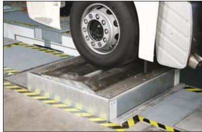
Mit der Hebevorrichtung HBV 4000 – nur in Verbindung mit BDE 4504 N 20 t mit Radlastwaage – können verschiedene Achslasten simuliert werden. Die Mechaniken werden angehoben und gegen das prüfende Fahrzeug gedrückt.
