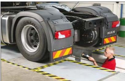
Der Gelenkspieltester GST 4500 ist eine sinnvolle Ergänzung bei der Annahme oder Inspektion, um eine optische Kontrolle der Achsspiele vorzunehmen. Die verzinkten Prüfplatten werden mit Fingerdruck auf die Prüflampe hydraulisch bewegt. Die Prüfplatten sind einzelsteuerbar, in gegenläufiger (4 Wege) oder in gleichlaufender Prüfrichtung (8 Wege) steuerbar.
