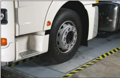
Damit kann die Spurabweichung des Fahrzeuges sofort gemessen werden. Das Ergebnis der Vor- bzw. Nachspur wird auf dem integrierten LED-Display (Option) im Anzeigeschrank oder als Bildschirmgrafik auf dem Monitor (Option) angezeigt.
