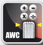
Calcul automatique de la largeur de la roue (fonction AWC) même si le capteur externe AWD ne figure pas sur la machine. L'équilibruse effectue une prévision de la largeur de la roue en réduisant les temps des opérations (\*).
